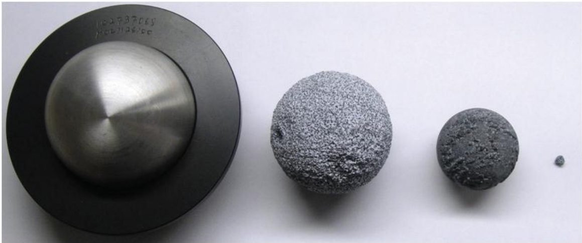
Figuur 4. Verschillende stadia van desintegratie van een IN-Tallic frack-bal in zoute vloeistof. Links een nieuwe bal. De tweede bal heeft 24 uur in zoute vloeistof gelegen en de bal aan de rechterkant 20 dagen (Bron: Baker Hughes [9]).
